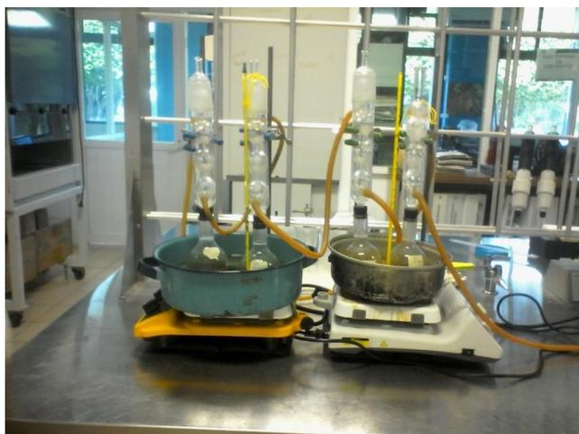
**Figura 13.** Equipo de hidrólisis.
